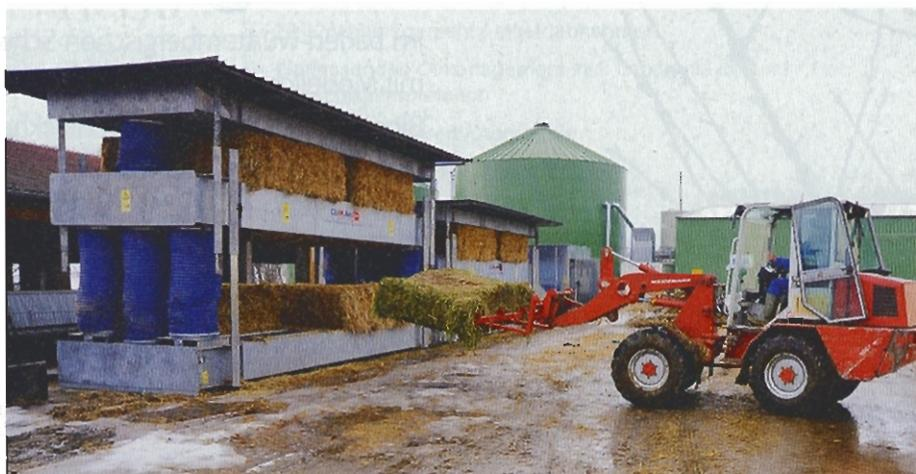
Mit einer Gabel werden die Luzerneheuballen in der Trocknungsanlage positioniert. Dazu werden der Zwischenboden oder für die Bestückung der oberen Ablage die Abdeckung hochgefahren. Im Hintergrund die Biogasanlage, deren Abwärme die Trocknung mit Wärme versorgt.
